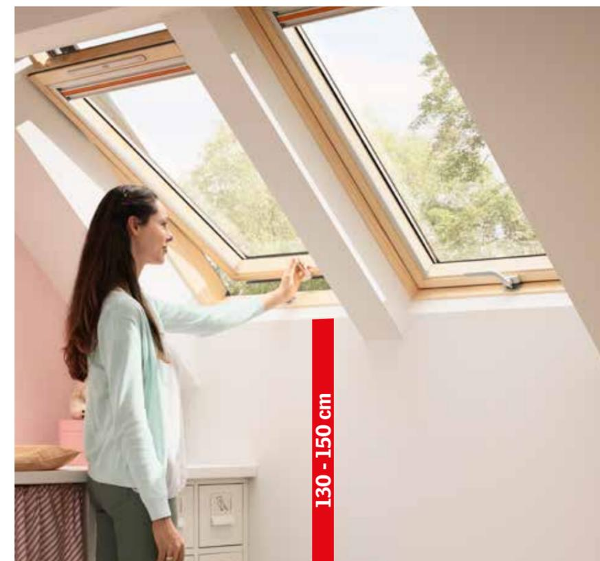
Un parapet înalt impune montarea la înălțime a ferestrei de mansardă. În acest caz, mânerul din zinc poziționat în partea de jos face ca această fereastră să fie operată cu ușurință. Cele două poziții de ventilare permit aerisirea încăperii cu fereastra închisă.
