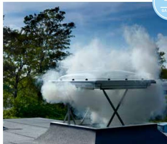
În cazul unui incendiu, senzorul de fum activează motorul electric care deschide fereastra 50 cm, pentru evacuarea fumului. Unitatea de control (KFX/KFC) are și funcție de ventilare de confort, care permite deschiderea ferestrei 15 cm.
