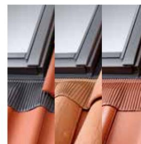
Șorțul ramelor de etanșare pentru învelitori ondulate are o structură tip sandviș, alcătuită din două straturi de aluminiu și un strat de butil, la interior. La comandă, se pot aduce rame cu șorț de culoare galbenă sau roșie, pentru a se integra cât mai discret în acoperișul tău.
